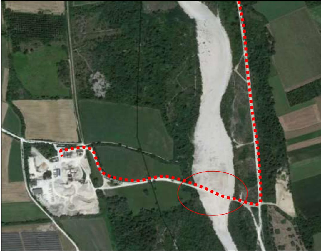
Il guado esistente di via Premariacco, 700 metri a sud dell'area di intervento, per raggiungere l'impianto "g" Gesteco. Tale alternativa consente di diminuire sensibilmente il traffico prospettato lungo la SS. 54 Udine Cividale.
