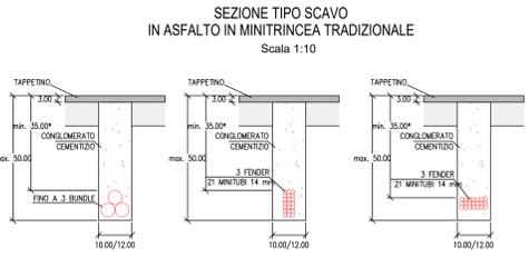
SEZIONE TIPO SCAVO IN ASFALTO IN MINITRINCEA TRADIZIONALE - Scale 1:10
